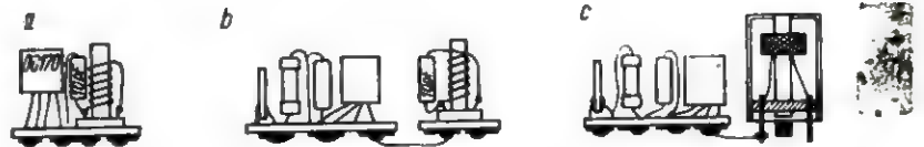
Rys. 3. Przykłady modułów a — moduł zawierający cewkę, b — moduł zawierający obwód rezonansowy połączony z modulem bez cewki, c — obwód rezonansowy w kubku ekranującym połączony z modulem bez cewki
